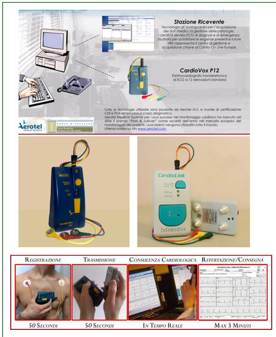
Figure 2. Telemetry device for remote electrocardiogram recording and its use. Un dispositif de télécardiologie pour l'enregistrement des ECG à distance et son utilisation.
